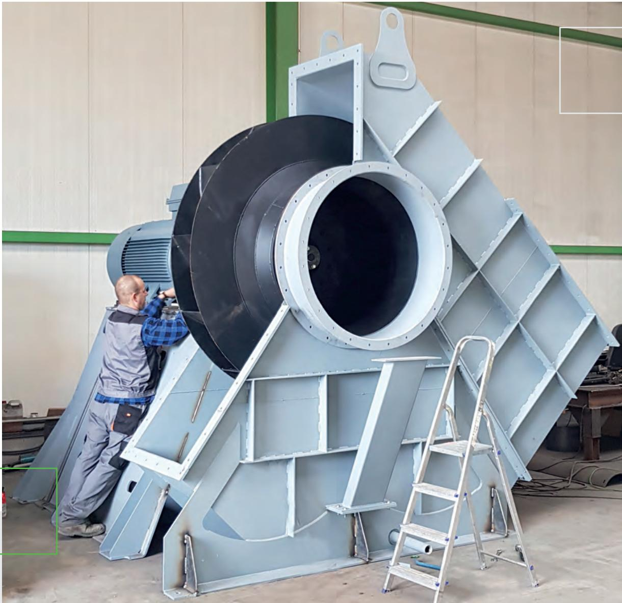
Das Ventilatorgehäuse hat den inneren Umriss einer Spirale.
