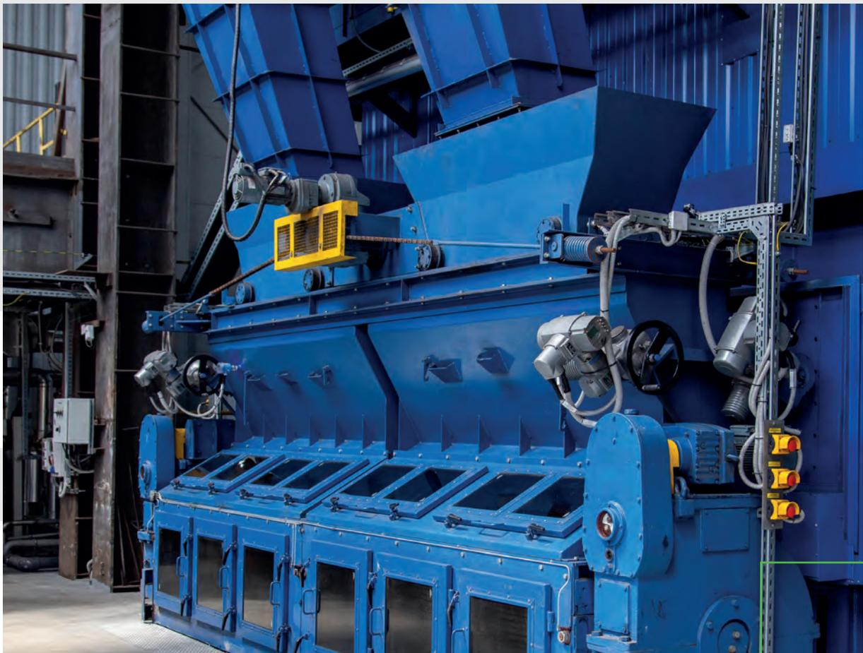
Bei Kesseln von 6 MW bis 50 MW werden schwere Deckbandroste (Typen RW, RTW, RTWC, RTWK, RTP) verwendet.
